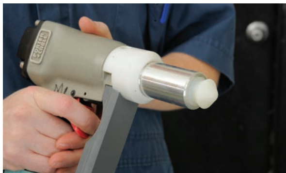
Le pistolet pneumatique modifié, muni d'une cheville percutante non pénétrante à tête conique permet d'euthanasier des porcelets pesant jusqu'à 9 kg.
